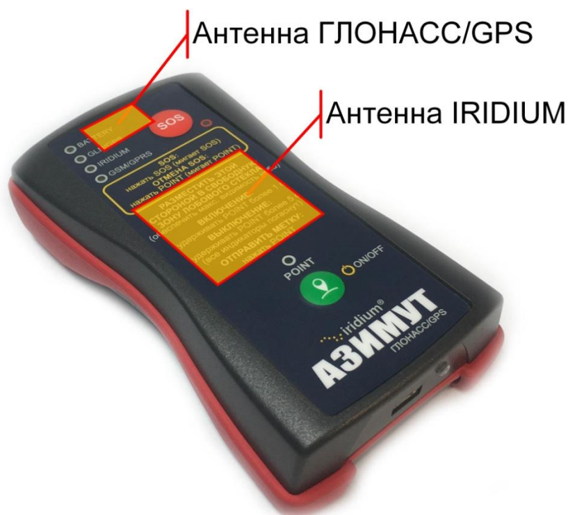
Рисунок 4 - Расположение встроенных антенн трекера
