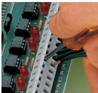
Подсоединение проводника „фронтальный электромонтаж“, серия 236
